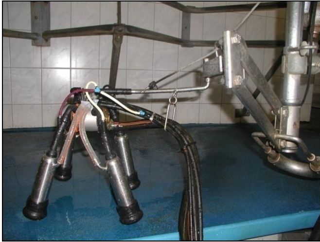
Abbildung 1: Versuchsaufbau des AktivPuls-Melkzeuges Figure 2: The technological design
