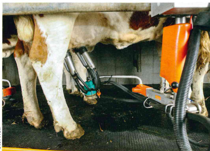
Positiv: Die Kuh steht auf einer Gummimatte, ein Nachmelkautomat führt das Melkzeug und verbessert den Ausmelkgrad.
