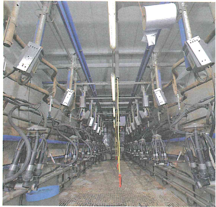
DeLaval, 2x10: Der Melker steht auf einem Gitterrost. Wasser kann so schnell abfließen, es kann sich aber Dreck ansammeln.
