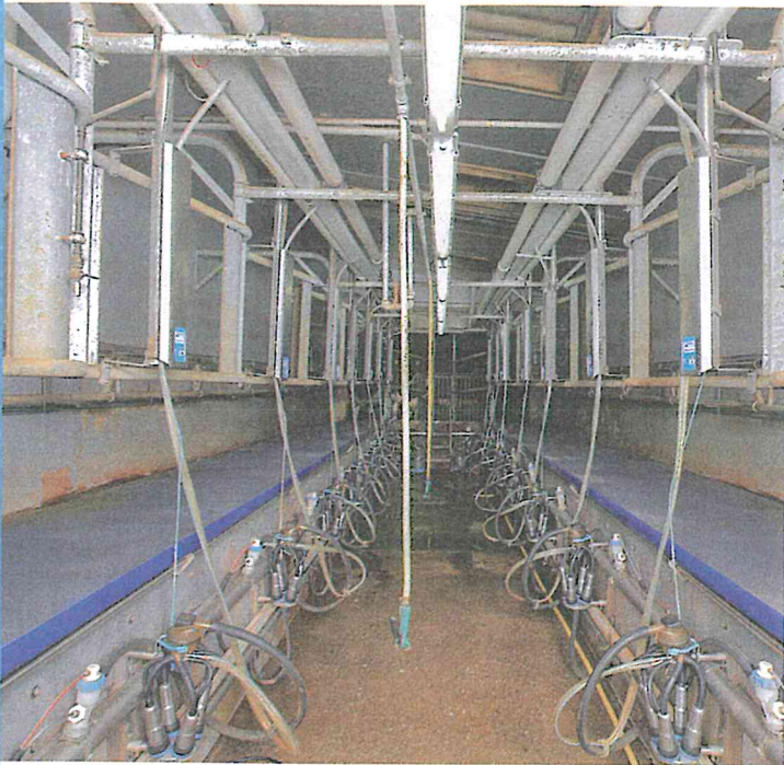
Boumatic, 2x9: Unser Testbetrieb hat den Melkstand im Umbau platziert. Daher die relativ schmale Melkgrube und Melkplätze.
