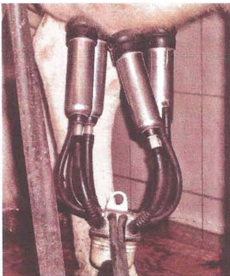
Werden Melkzeuge nicht gerade ausgerichtet, leiden Melkgeschwindigkeit und Ausmelkgrad.
