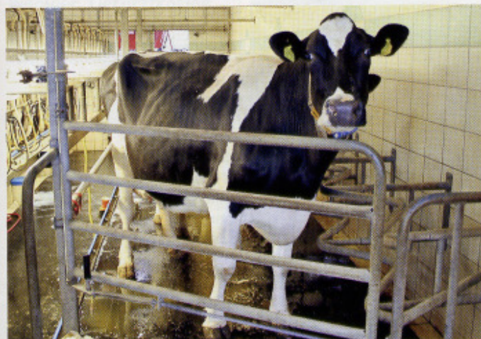
Schwachstelle Türen und Tore: Viele unserer Leser klagen über zu schwache Türen und Zylinder, Verarbeitungsmängel, Lärmbelästigung oder das Einklemmen der Kühe (links). Boumatic (rechts) schnitt hier am besten ab.
