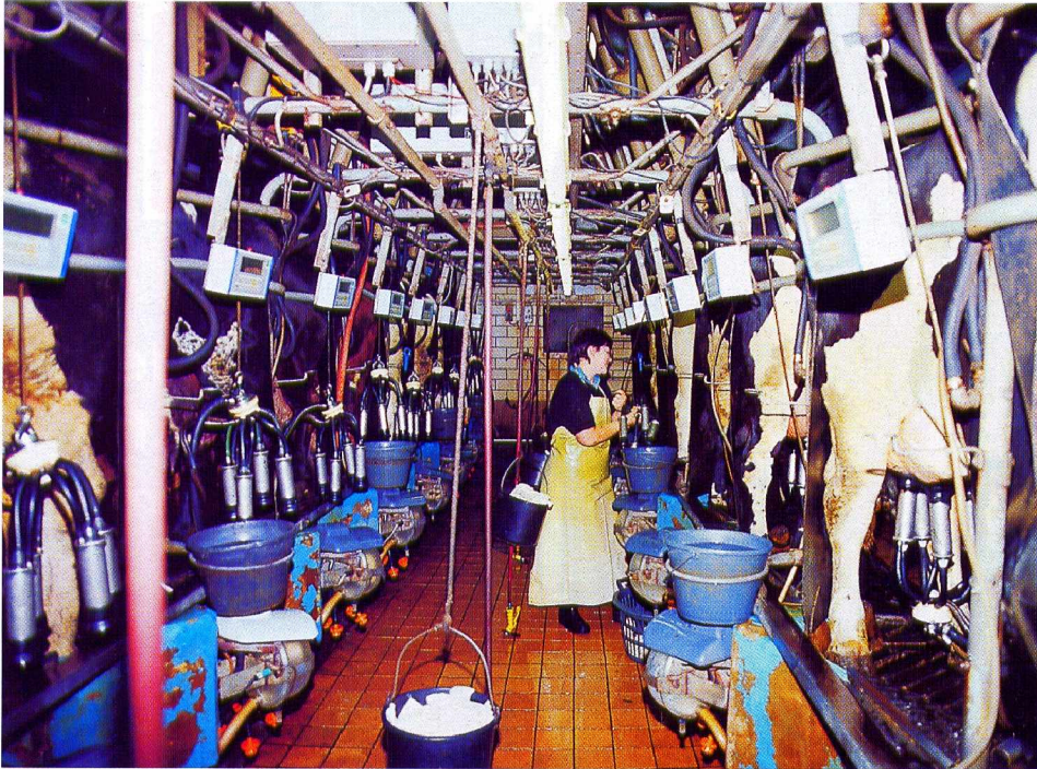
Auch in größeren Fischgräten-Melkständen (2 x 10 bis 2 x 12) können von einer Arbeitskraft 80 bis 100 Kühe pro Stunde gemolken werden. Fotos: Heil, Veauthier
