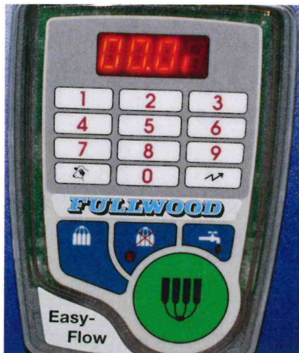
Gleichmäßig laufende Pulsatoren mit vollwertiger (zeitgesteuerter) Stimulationsautomatik steigern Melkgeschwindigkeit und Ausmelkgrad Fotos: Verfasser
