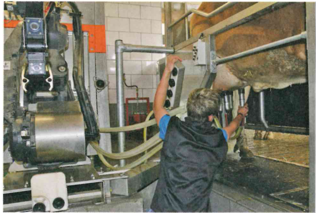
Problemkühe können beim AktivPuls® Robot 2020 auch manuell angesetzt werden. Der Bau einer kleinen Melkgrube bietet sich in diesem Zusammenhang an.
