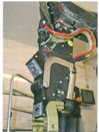
Für ein schnelles und sicheres Ansetzen der Melkbecher wird eine neue Kombination aus Laser und Kamera verwendet.
