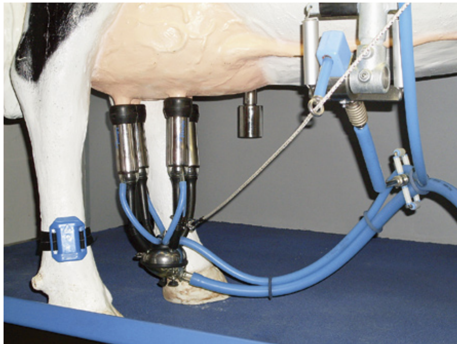
Die einfachste Möglichkeit der Zitzenschonung: Gleichtakt pulsation und Anheben der Milchschräume.
